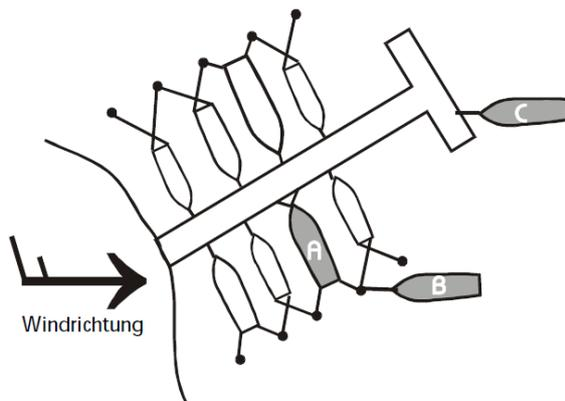
Das Boot liegt auf Position A. Um Segel setzen zu können, muss das Boot zunächst auf einen Platz verholt werden, wo es genau im Wind liegt. Das wäre möglich auf Position B oder C. Dort wird erst das Großsegel und dann die Fock gesetzt.
